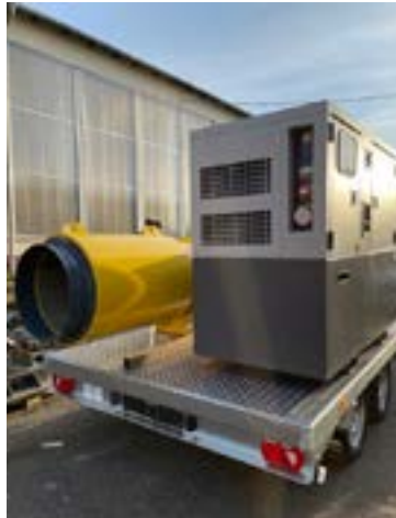
Spezialumbau eines Fahrwerkes versehen mit einem EPIROC AVH63 Tunnellüfter mit einem Atlas Copco QES30 mit Großtank.
