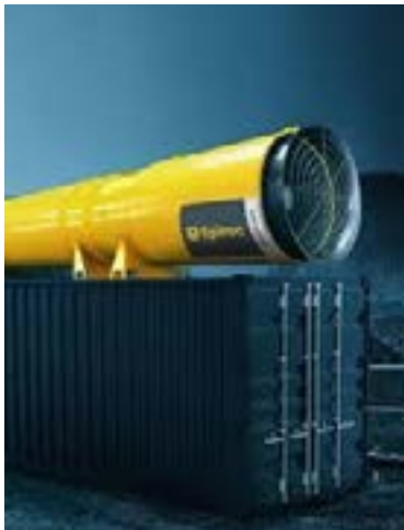
Spezialumbau eines Fahrwerkes versehen mit einem EPIROC AVH63 Tunnellüfter mit einem Atlas Copco QES30 mit Großtank.
