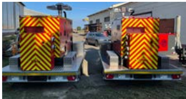
250 KVA Stage V Stromerzeuger QAS250 mit Spezialtrailer
