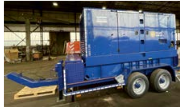
250 KVA Stage V Stromerzeuger QAS250 mit Spezialtrailer
